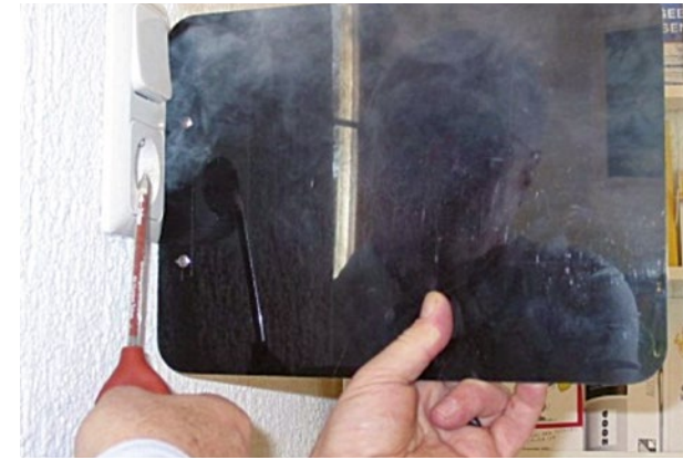
Abbildung 16 Verwendung von Rauchröhrchen
